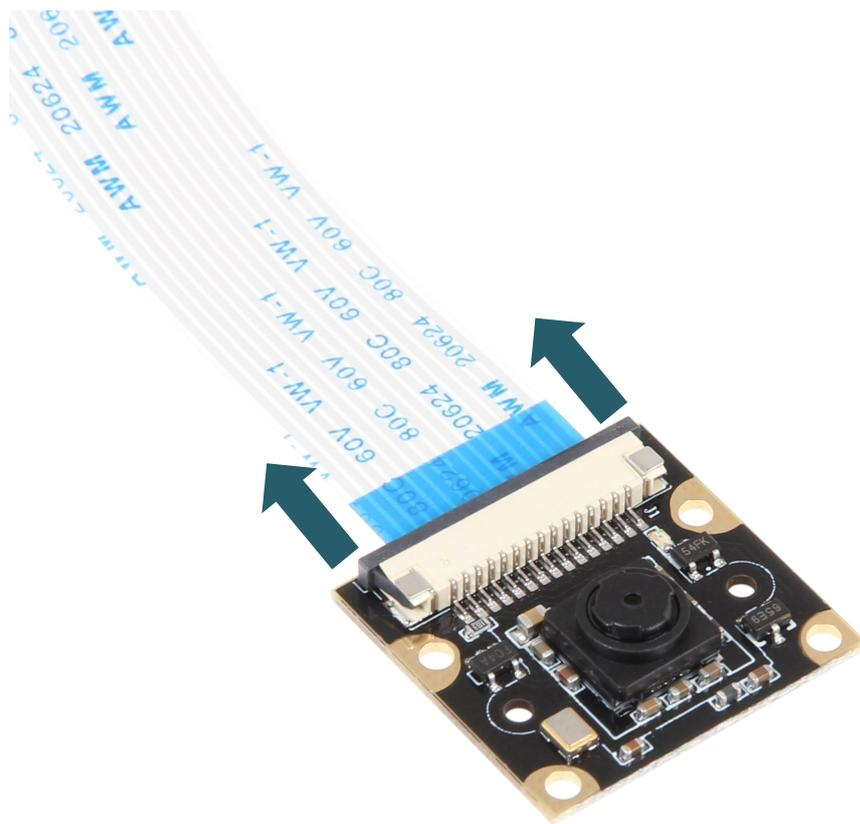
Als Nächstes können Sie das Flachbandkabel nun einfach herausnehmen und das passende Flachbandkabel für den Raspberry Pi 5 einlegen und **den Clip in die entgegengesetzte Richtung der oben gezeigten Pfeile drücken, um das Flachbandkabel wieder zu befestigen.**
