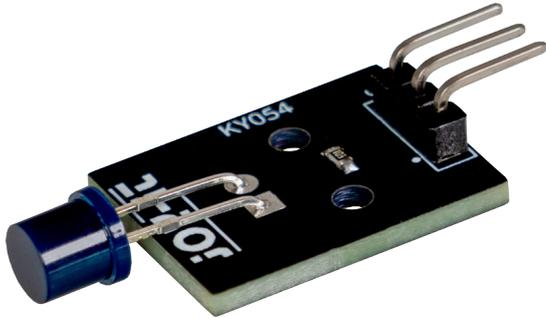
Der SEN-KY-054 Fototransistor ist ein kompakter und zuverlässiger NPN-Fototransistor.
