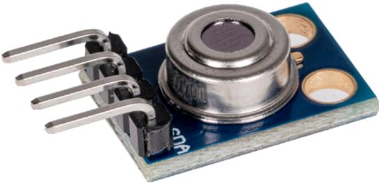
Dieses Infrarotsensor-Modul verwendet den MLX90614 Sensor und ermöglicht berührungslose Temperaturmessungen. Die Ansteuerung erfolgt besonders einfach über die I2C-Schnittstelle und ist damit mit verschiedensten Mikrocontrollern und Einplatinencomputern möglich.
