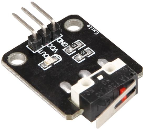
Unser Bump-Sensor erkennt automatisch den Kontakt mit einem Hindernis und sendet das digitale Signal über den Ausgabe-Pin an ein entsprechendes Gerät weiter.
