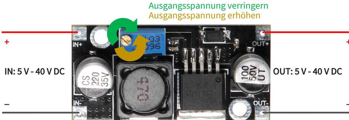
Schließen Sie den Spannungswandler mit dem Kontakt IN+ an den positiven Pol und mit dem Kontakt IN- an den negativen Pol Ihrer Gleichspannungsquelle.
