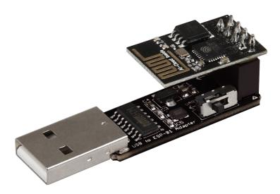
Neben dem gelben Connector befindet sich ein kleiner Schalter (ebenfalls auf den Bild zu erkennen). Achten Sie darauf, dass dieser auf **Prog** gestellt ist, wenn Sie Ihren ESP8266 programmieren möchten. Für eine reguläre Verwendung des Moduls, stellen Sie das Programmiermodul auf **UART**.
