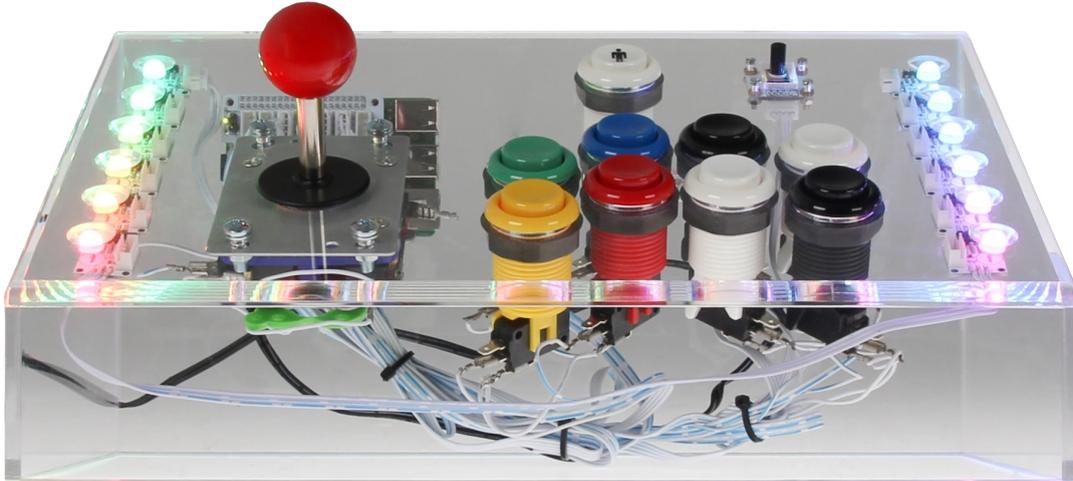
Die aktuell eingestellte Lichtshow lässt sich durch Drehen des oben rechts angebrachten Drehpotentiometers ändern.
