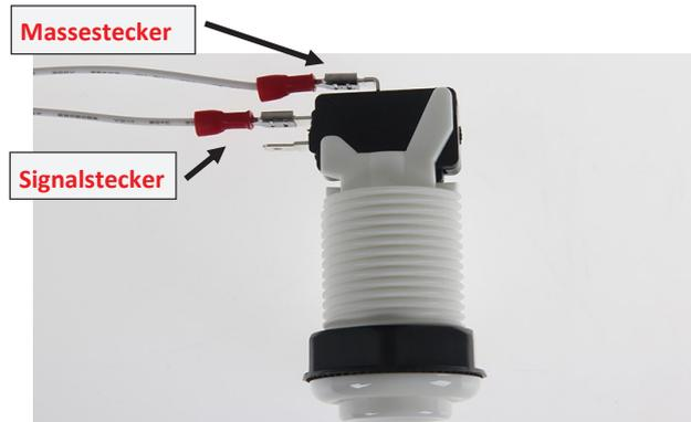
Das Gleiche machen Sie mit dem verbliebenen Signalstecker, mit dem Unterschied, dass Sie diesen in den mittleren Kontakt des nächsten Knopfs stecken.
