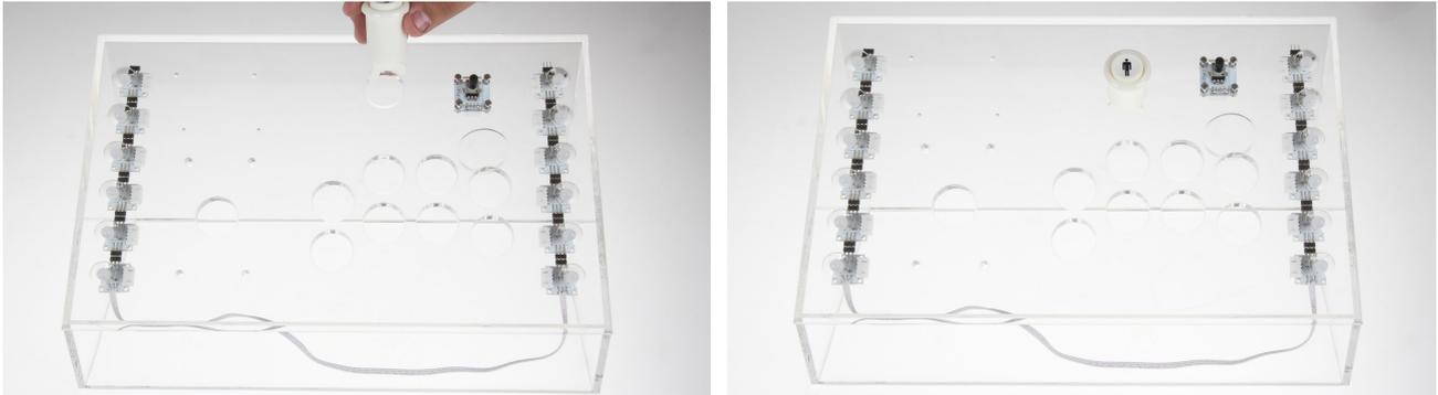
Dann drehen Sie das Gehäuse um und schrauben den Knopf mit Hilfe der Mutter fest.
