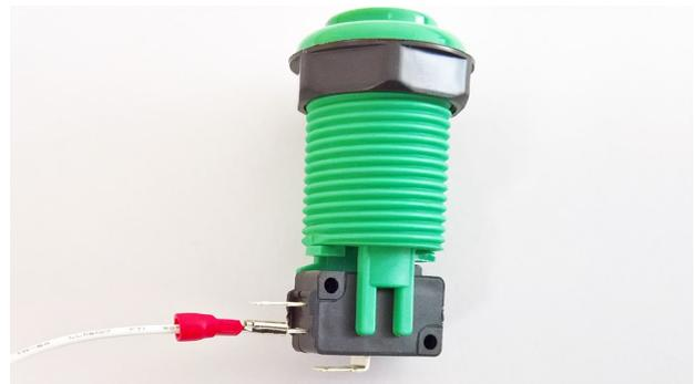
Die Massestecker werden auf die unteren Kontakte der Mikroschalter gesteckt.
