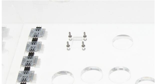
Anschließend setzen Sie das Potentiometer auf die Schrauben und befestigen es mit vier weiteren Muttern [G].
