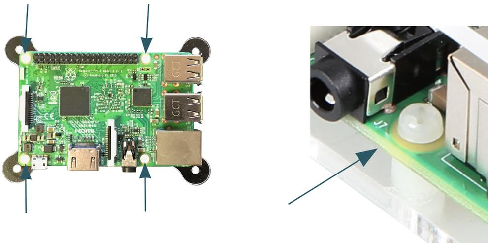
Schrauben Sie als erstes an die Grundplatte (Platte mit Wandhalterung) die Abstandshalter mit Gewinde fest. Verwenden Sie die Abstandshalter mit Gewinde, damit die nächste Platte oben drauf gelegt werden kann.
