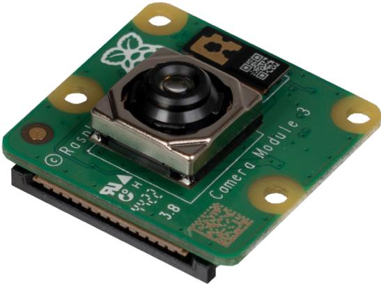
Das Raspberry Pi Kamera Modul 3 ist eine kompakte Kamera für den Raspberry Pi, die mit einem 12 Megapixel großen Sony IMX708 Sensor ausgestattet ist.
