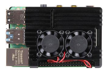
4. Nun drehen Sie den Pi mit dem Deckel um, setzen den Boden auf den Raspberry Pi 4 und schrauben das Gehäuse am Boden fest mit den übrigen Schrauben mit dem dicken Kopf.
