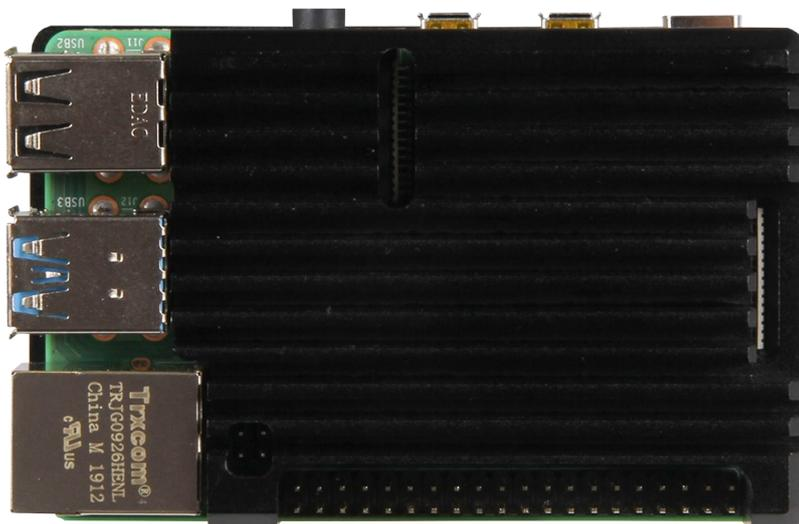
3. Nun drehen Sie den Pi 4 mit dem Deckel um, setzen den Boden auf den Raspberry Pi 4 und schrauben das Gehäuse am Boden fest mit dem im Lieferumfang enthaltenen Innensechskantschlüssel.
