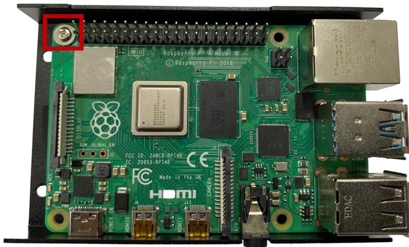
2. Nun können Sie die Seiten in den Gehäuseboden schieben und festschrauben.
