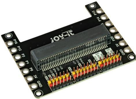
Dieses Sensor-Shield hilft Ihnen, mehrere Sensoren an Ihren micro:bit anzuschließen. Alle IO-Pins werden jeweils zusammen mit einem GND und 3 V Pin über die 3-Pin-Schnittstellen hinausgeführt. Dies macht es einfach, Sensoren mit Jumper-Drähten zu verbinden. Außerdem können Sie die Versorgungsspannung für Ihren micro:bit auch über das Breakout-Board an die 3 V- und Ground-Pins anschließen.
