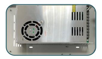
5. Schrauben Sie nun die Lüftersteuerung neben dem Labornetzteil mit den restlichen schwarzen Schrauben fest und schließen Sie den Lüfter an den dazu vorgesehen Anschluss an.
