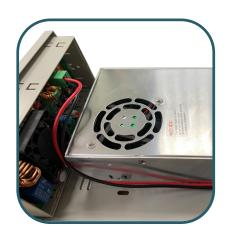
7. Sie können nun auch den Anschluss von der Herausführung des Temperatursensors anschließen, wenn Sie den Temperatursensor aus dem Gehäuse führen wollen. Ansonsten schließen Sie nun den Temperatursensor an.
