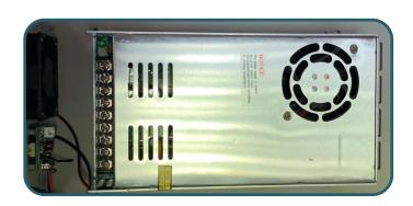
4. Schließen Sie nun den Lüfter an die Lüftersteuerung an und die Lüftersteuerung an das Netzteil. Dazu verbinden Sie die schwarzen Kabel der Lüftersteuerung und die des Labor-Netzteils mit den dafür vorgesehen Terminals V- und die roten Kabel mit den V+ Terminals.
