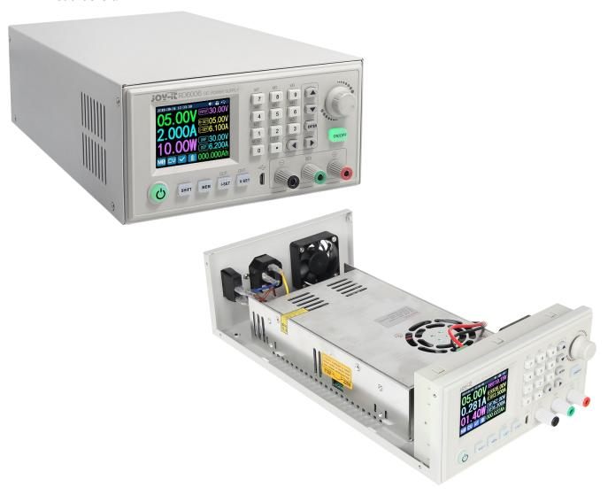
Sie können mit Hilfe eines Feineinstellpotentiometers die Ausgangsspannung am RD6006-NT einstellen. Diese können Sie an der Eingangsspannung des RD6006 / RD6006P sehen. Idealerweise hat das RD6006 / RD6006P eine Eingangsspannung von 65 V, damit die vollen 60 V ausgegeben werden können.
