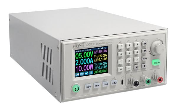
Sie können mit Hilfe eines Feineinstellpotentiometer die Ausgangsspannung am RD6006-NT eingestellt werden. Dies können Sie an der Eingangsspannung des RD6006 / RD6006P sehen. Idealerweise hat das RD6006 / RD6006P eine Eingangsspannung von 65 V, damit die vollen 60 V ausgegeben werden können.
