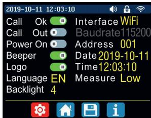
Drücken Sie **SHIFT + 0**, um das Systeminstellungsmenü aufzurufen. Mit Hilfe der Richtungstasten kann die gewünschte Einstellung ausgewählt werden. Die aktuelle Auswahl wird dabei rot hinterlegt. Durch einen Druck auf den Encoder kann die Einstellung geändert werden.
