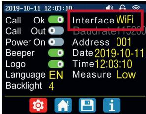
Alternativ zur USB-Verbindung kann das Labornetzgerät auch durch das Funkmodul per WiFi gesteuert werden. Für eine Steuerung per WiFi muss die entsprechende Schnittstelle zunächst auf dem Gerät aktiviert werden. Öffnen Sie hierzu die Einstellungen, indem Sie **SHIFT** und **0** drücken und stellen Sie hier die Interface-Option auf **WiFi**. Bitte beachten Sie, dass die Änderungen erst nach einem Neustart des Gerätes wirksam werden.
