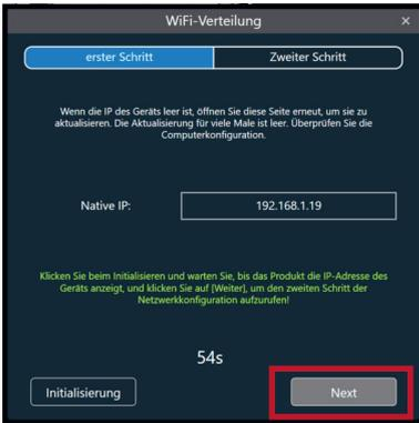
Klicken Sie nun in dem sich öffnenden Fenster auf **Initialisierung**. Starten Sie jetzt das Labornetzgerät und warten Sie, bis auf dem Gerät die IP-Adresse Ihres Computers angezeigt wird. Klicken Sie anschließend auf **Next**.
