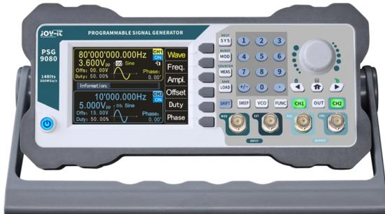
Der programmierbare Signalgenerator PSG9080 kann viele verschiedene Wellenformen wie z. B. Sinus-, Rechteck-, Dreieck-, Puls- und Benutzerdefinierte Wellen erzeugen. Der Signalgenerator hat einen großzügigen Frequenzbereich, der von 1Hz bis 80MHz reicht und eine Abtastrate von 300 MSa/s.
