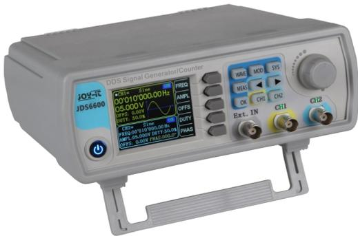
Der JT-JDS6600 Signalgenerator und Frequenzzähler kann Signale bis 60MHz in verschiedenen Wellenformen erzeugen und bietet mit seinem Frequenzzähler eine hervorragende Qualität. Er lässt sich mit seinen Tasten intuitiv bedienen. Außerdem kann das Menü in den Sprachen Deutsch, Englisch und Französisch dargestellt werden.
