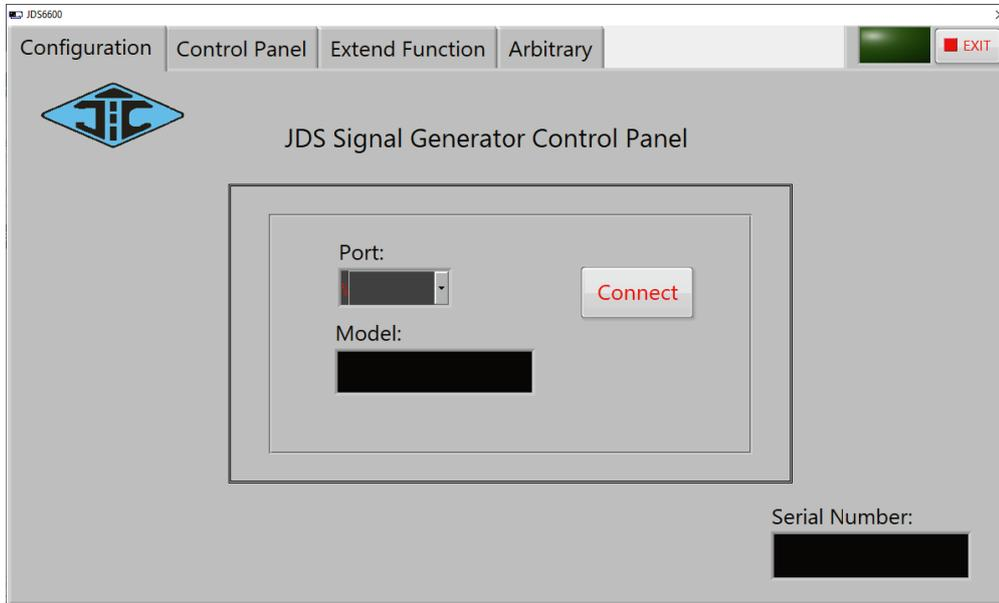
Stellen Sie anschließend die Verbindung mit **Connect** her. Im **Control Panel**, welches Sie über den Reiter im oberen Bereich der Software erreichen, können Sie die Standardwellenformen und Funktionssignale ausgeben.
