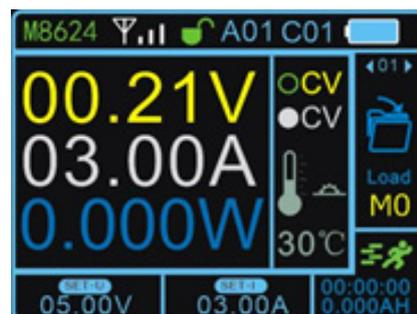
Wenn der Laststrom den gesetzten maximal Strom erreicht, dann ist der Ausgangstrom gleich wie der gesetzte Strom und das Gerät wechselt zu dem Konstantstrom, welches zur Folge hat, dass die CC-LED aufleuchtet.
