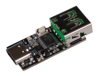
Mit diesem kleinem Modul können Sie USB-PD Protokolle auslösen und somit zum Beispiel Ihren Laptop über ein PD-fähiges USB-C Netzteil laden. Die Ausgangsspannung ist über den auf dem Modul integriertem Knopf in 5 Stufen (5 V, 9 V, 12 V, 15 V und 20 V) einstellbar. Die momentan ausgewählte Spannung kann an der Farbe der auf dem Modul integrierten RGB-LED abgelesen werden. Das Modul ist aufgrund seiner Ausgangsschnittstellen flexibel einsetzbar und leicht zu integrieren.
