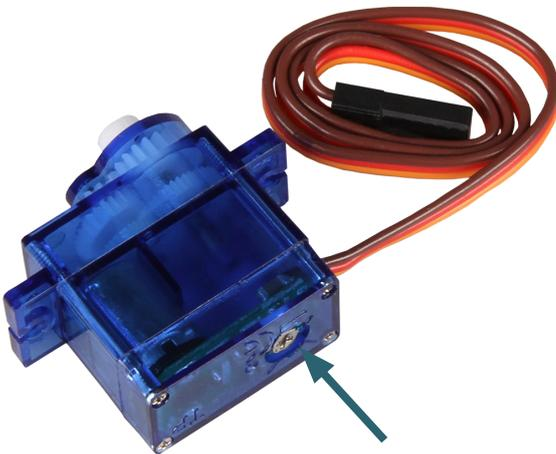
Auf der Unterseite des Servomotors befindet sich ein Potentiometer, welches den Motor kalibriert.
