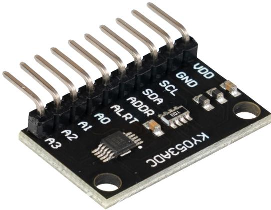
Der Raspberry Pi besitzt im Gegensatz zum Arduino keine analogen Eingänge bzw. es ist kein ADC (analog digital converter) im Chip des Raspberry Pi's integriert. Dies schränkt den Raspberry Pi ein, wenn man Sensoren einsetzen möchte, bei denen Werte nicht digital ausgegeben werden können.
