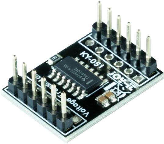
Dieses Modul wandelt digitale Signale von einer Spannung zu einer anderen herunter oder herauf. Dadurch ist es möglich auch mit 3 V Systemen, wie dem Raspberry Pi, Sensoren und Module, die mit 5 V Logik arbeiten, zu betreiben und umgekehrt.
