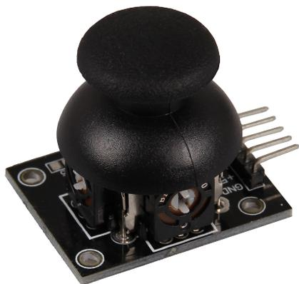
Die X und Y Position des Joysticks, werden als analoge Spannung auf den Ausgangspins ausgegeben. Zusätzlich kann durch Drücken auf den Stick ein Knopf betätigt werden.
