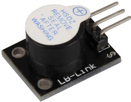
Mit Spannung betrieben, erzeugt der aktive Buzzer einen Ton. Das Modul kann fest verlötet oder mit einem Breadboard verwendet werden. Es ist kompatibel zu allen Raspberry Pi und Arduino Modellen.
