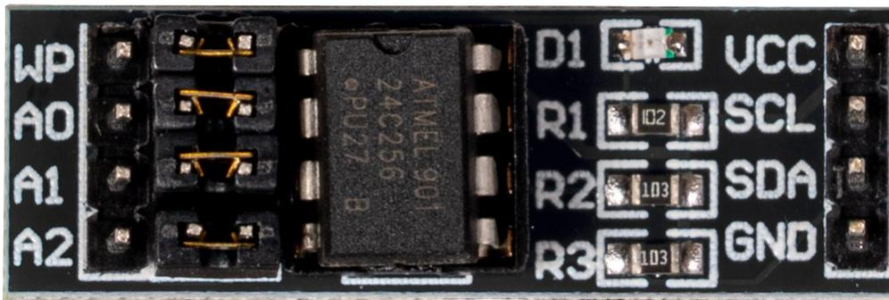
Das EEPROM Modul besitzt vier Jumper, welche weitere Einstellmöglichkeiten bieten. Dazu dienen die Jumper A0, A1 und A2 zur Einstellung der I2C-Adresse. Der Jumper WP (Write Protect) dient dazu ggf. das Beschreiben des EEPROMs zu verhindern. Dies ist aktiv, wenn der Jumper rechts gesteckt ist.
