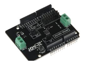
Mit dieser Erweiterungskarte wird ein Arduino um eine zusätzliche RS485-Schnittstelle erweitert.
