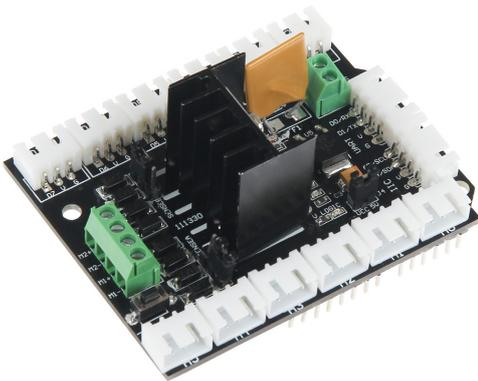
Motorshield zum direkten Aufstecken auf den Arduino
